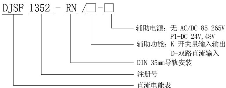
注:选配双路直流输入(D)功能时，如果电流通道均采用的是霍尔电流传感器输入，则需外配一个电源模块给第二路的霍尔传感器供电；如果未带D功能，则可使用电表内置电源。
