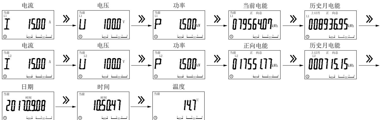
注：1、L1、L2 分别表示第一路、第二路直流输入，当未选配第二路直流输入时，L2 参数界面不显示；
